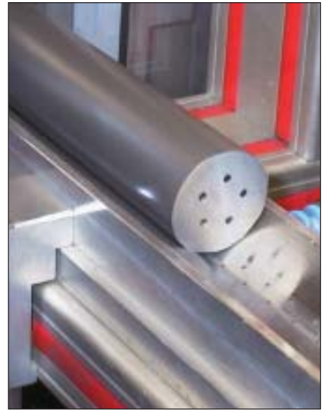
Strangpresse zur Herstellung von Hartmetallstäben mit Kühlkanälen. Extrusion press for the production of carbide rod with coolant ducts.
